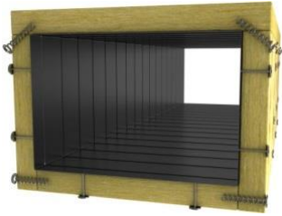
6.1 pav. Izoliacinių plokščių montavimas horizontaliam kanalui
