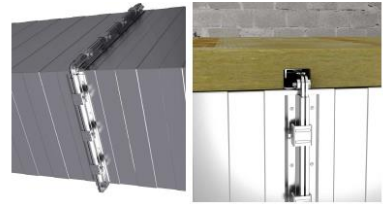
6.2 pav. Izoliacinių plokščių montavimas flanšų vietose
